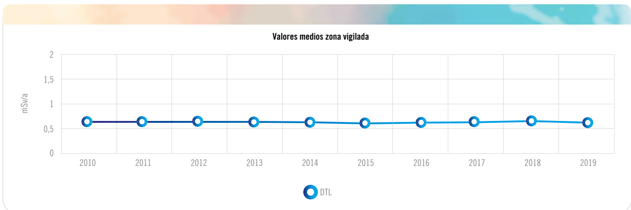
Gráfica 4.1.4.3.11. Radiación directa. Dosis integrada. Valores de los DTL. Central nuclear Ascó
